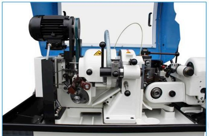
Rotierender Werkzeugkopf mit 10'000 oder 12'000 U/min.
